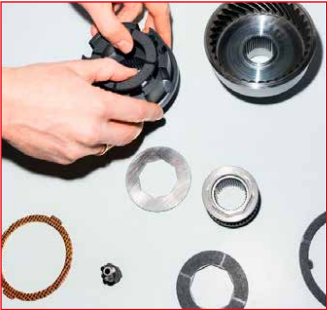
Bauteile des Mittendifferenzials, Herzstück vieler quattro Varianten, zeugen gleichermaßen von Präzision und In-novation.
