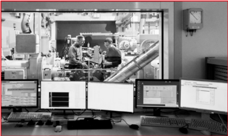
Im Getriebezentrum werden Antriebsstränge in Dauertests erprobt und wichtige Erkenntnisse auch zum quattro Antrieb ermittelt.
