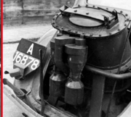
Durch Betätigung des Anlassers ließ man dann den Motor bei langsam geöffneter Luftdrosselklappe so lange Luft ansaugen bis ein zündfähiges Gasgemisch entstand und der Motor startete. Bis das zündfähige Gas jedoch in den Verbrennungsraum des Motors gelangen durfte, musste es einen Absitzbehälter zur Reinigung, einen Gaskühler zur Abkühlung sowie einen Nachreiniger, der allfällig noch immer vorhandene Schmutzpartikel herausfilterte, durchlaufen.
