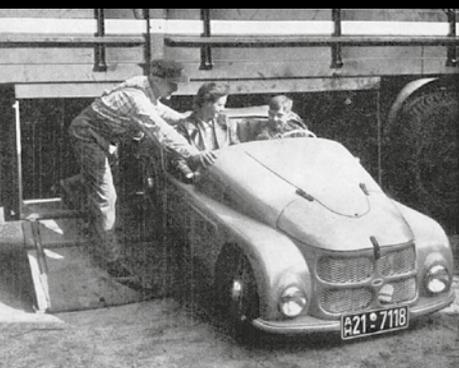
Mit abgeschraubter Windschutzscheibe konnte der Kleinschnittger als Notfahrzeug im Werkzeugraum unter der LKW-Pritsche mitgeführt werden.
