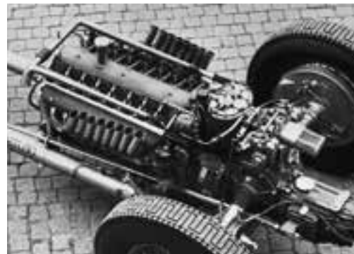
Das Chassis des Auto Union Rennwagens Typ C aus 1936 lässt einen wunderbaren Blick auf den spektakulären V16 zu. 2000 präsentierte Audi das Concept Rosemeyer mit W16-Motor, musste aber letztlich Bugatti den Vortritt für die Serie überlassen.
