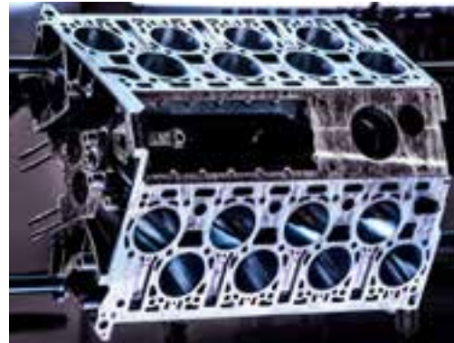
oben: der gewaltige Motorblock des Bugatti W16-Motor, gut zu erkennen die zwei VR8-Blöcke. unten: im eingebauten Zustand im Form des „Bolide“: mehr Motor als Auto.
