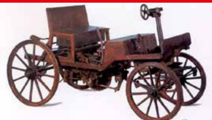
Zweiter Marcus Wagen: Der Motor wurde 1888, das Fahrgestell später von der Fa. Märky, Bromovsky & Schulz in Adamsthal nahe Brünn angefertigt.
