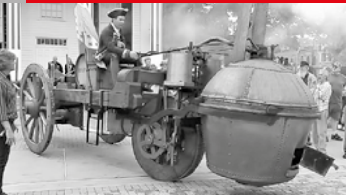
Mit viel Dampf gegen die Wand: Cugnots „Fardier à vapeur“ sollte militärischen Zwecken dienen.
